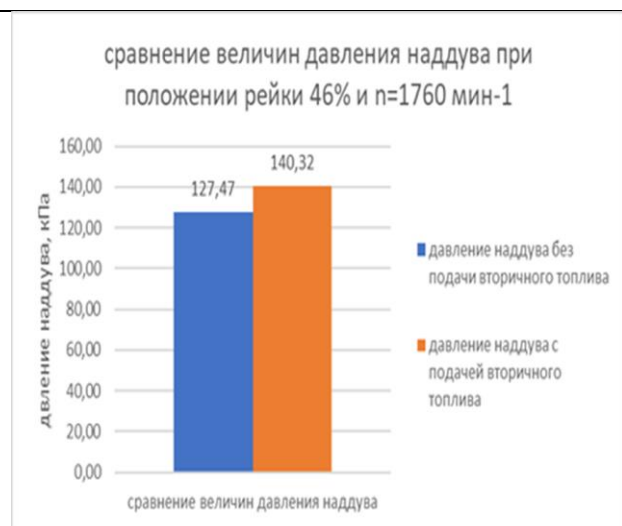
Рисунок 101- Сравнение величин давления наддува при положении рейки 46%
