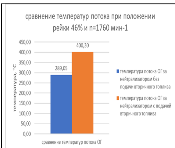
Рисунок 102-Сравнение температур при положении рейки 46%
