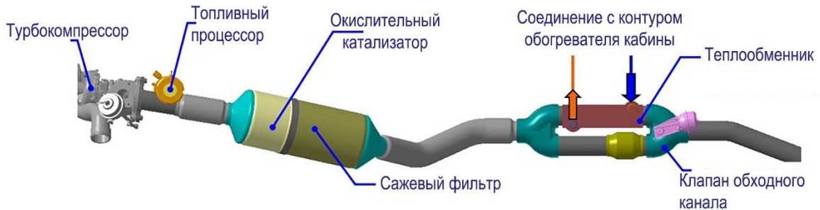
Рисунок 17-Система рекуперации теплоты отработавших газов (рисунок © Eberspacher)
