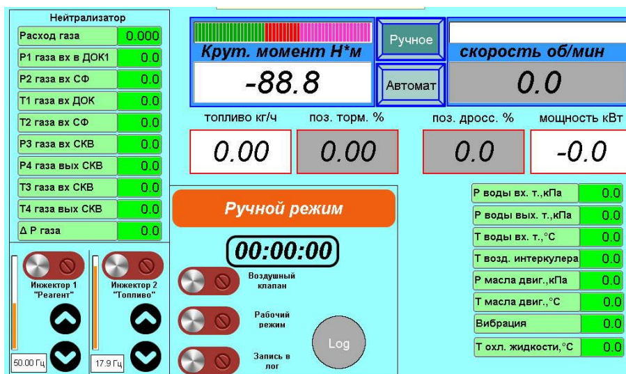
Рисунок 84-Снимок главного экрана системы управления на панели оператора в рабочем режиме
