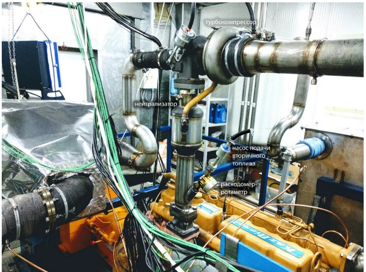
Рисунок 88-Установка нейтрализатора с насос-форсункой подачи вторичного топлива
