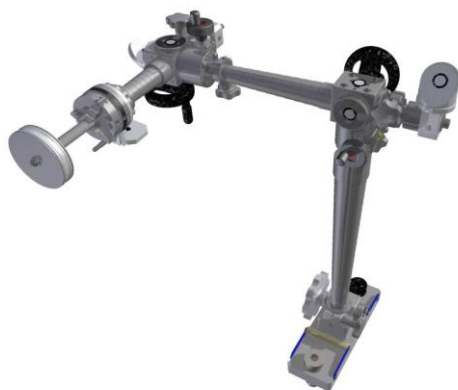
Рис. 4. Стойка с цанговым зажимом и телескопической защитой
