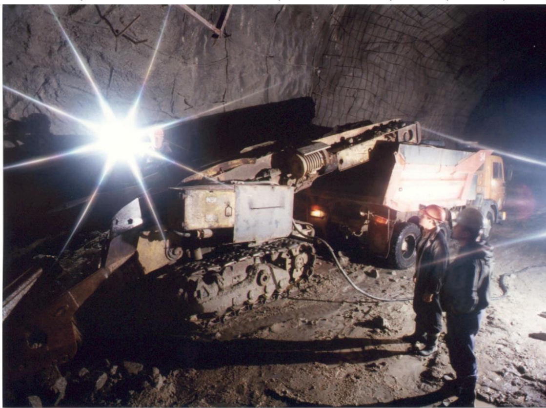
Рис. 4.9. Породопогрузочная машина ПНБ-3Д на гусеничном ходу.
