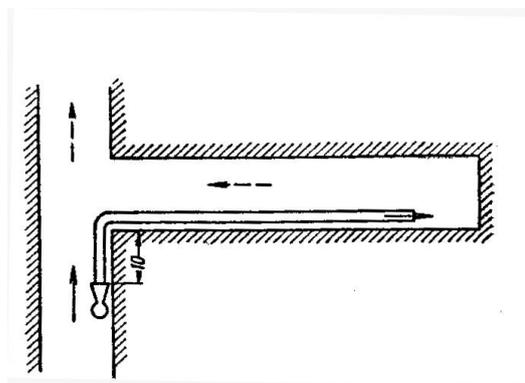
Рис5.2. Нагнетательное проветривание
