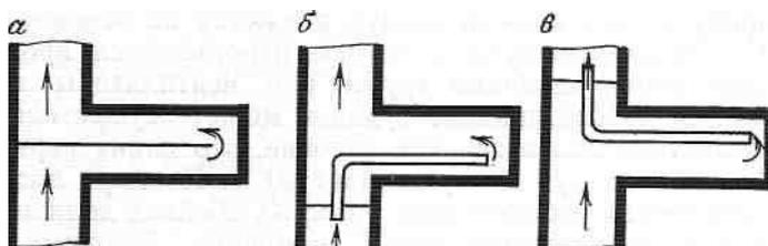
Рис.5.1. Схемы проветривания тупиковых выработок за счет общешахтной депрессии с применением продольной перегородки (а) и вентиляционной трубы, подающей воздух в забой (б) и отсасывающей воздух из забоя (в)
