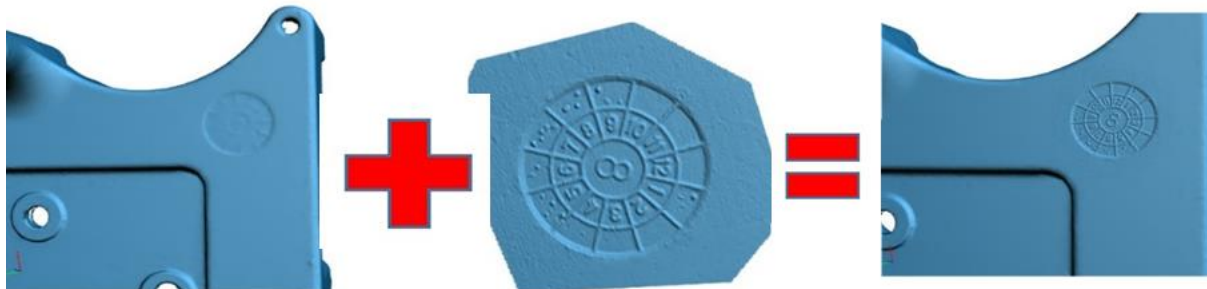
ж) применение техники совмещённого сканирования для получения полигональных моделей с высокой степенью детализации (деталь №1)
