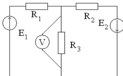
В электрической схеме определить показание вольтметра.
