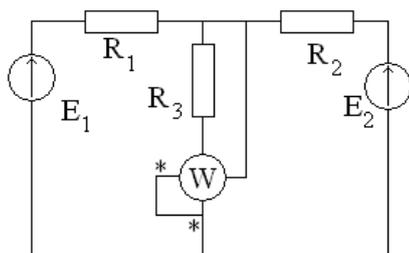
В электрической схеме определить показание ваттметра.
