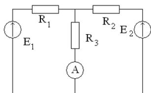
В электрической схеме определить показание амперметра.
