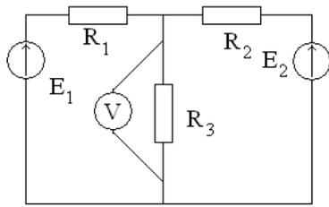
В электрической схеме определить показание вольтметра.
