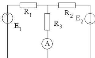
В электрической схеме определить показание амперметра.
