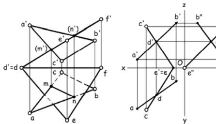
3. Построить проекции треугольника ABC, если сторона BC лежит на прямой MN, параллельной плоскости H, а сторона AC параллельна плоскости V. Основание D высоты AD делит сторону BC в отношении  $|BD| : |DC| = 1 : 2$ .
