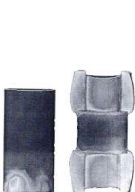
интенсивность напряжений, МПа: начало процесса; конец процесса
