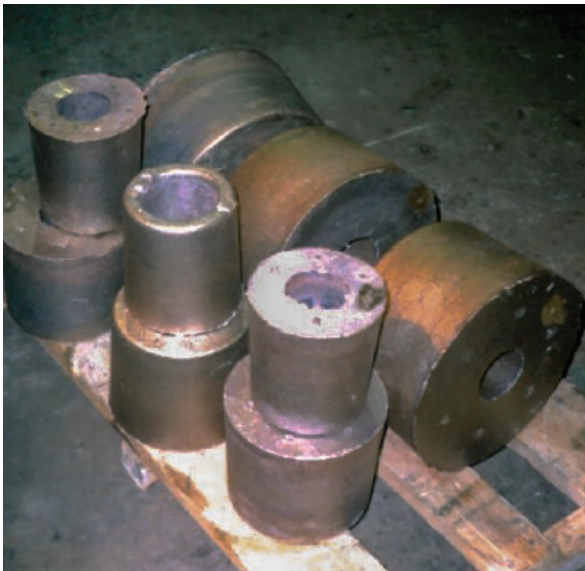
✦ Стержни из оловянистой бронзы для проведения испытаний, отлитые на ЗИЛе
