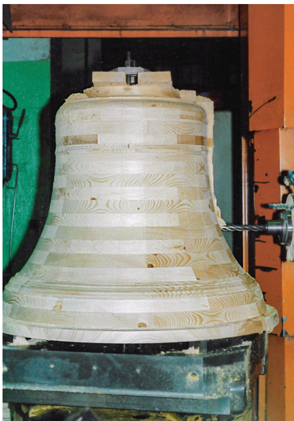
➤ Обработка деревянной модели малого колокола (диаметром менее 1,5 м) на станке с ЧПУ
