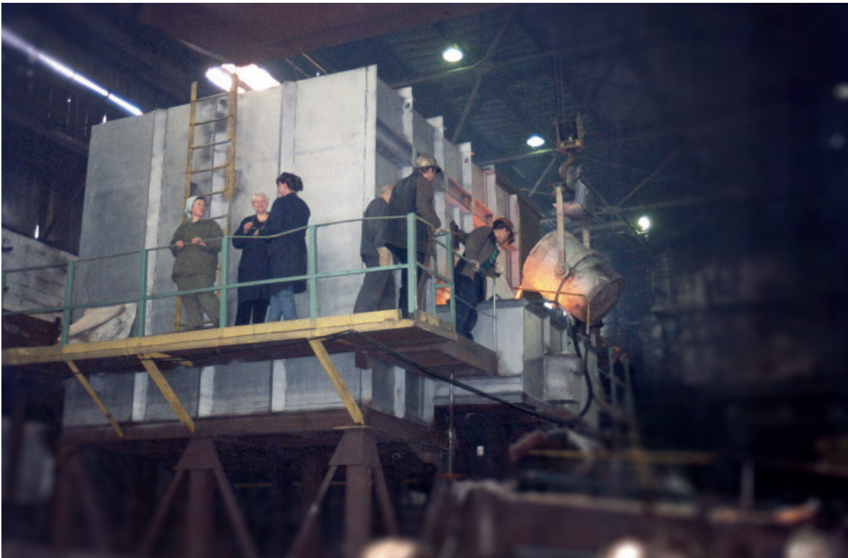
🔥 Газоплавильная 42-тонная печь
