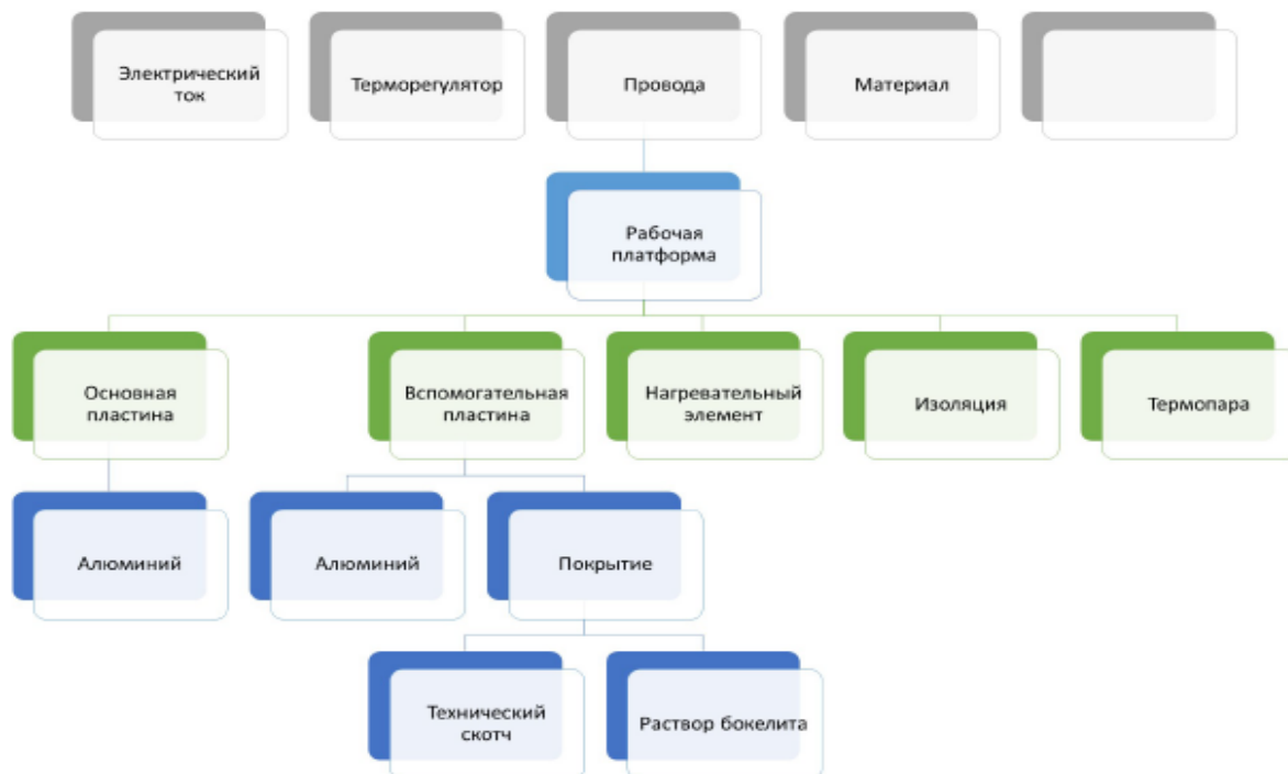
Рисунок 3 – Структурная схема подсистемы «рабочая платформа» устройства 3Д-принтер. Инженеру понадобилась большая детализация для решения технической проблемы
