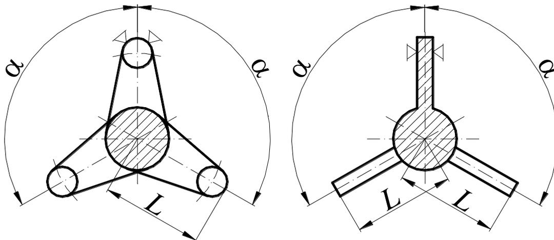
$L$ -длина элемента (расстояние от оси поковки до торца элемента)
