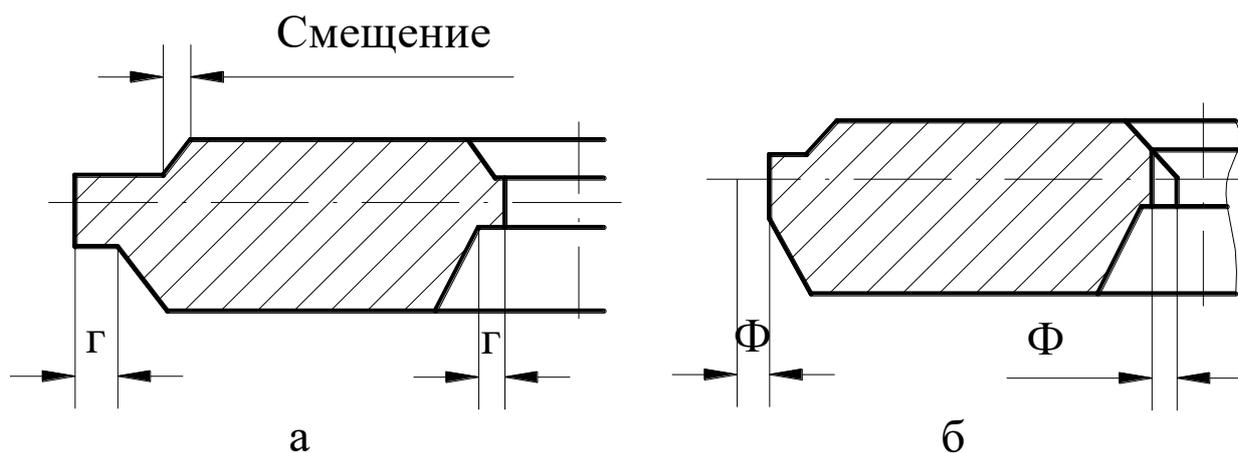
Рис. 1.5. Остаточный облой – а; срезанная кромка – б.
