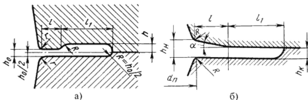
Рис.14.1. Виды облойной канавки при штамповке на молотах
