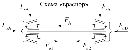
Рис. 14.2. К определению осевых расчетных нагрузок на подшипники ( F_{aA} и F_{aB} )
