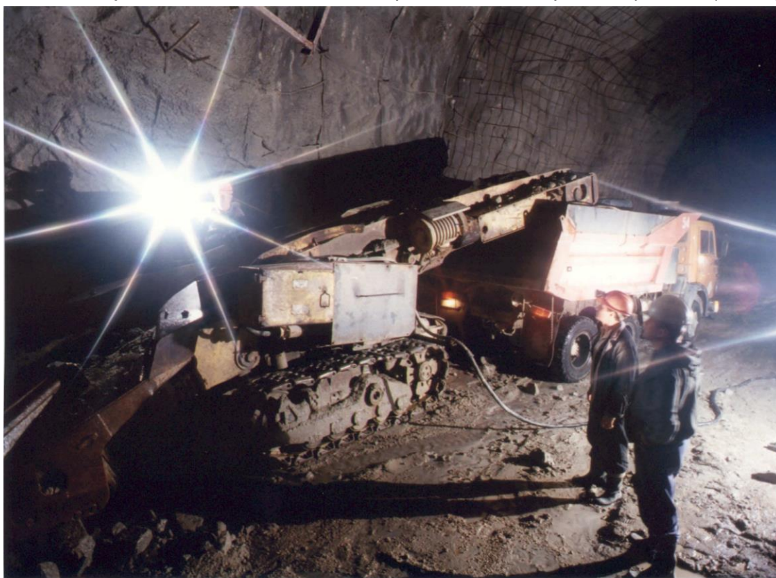
Рис. 4.9. Породопогрузочная машина ПНБ-3Д на гусеничном ходу.
