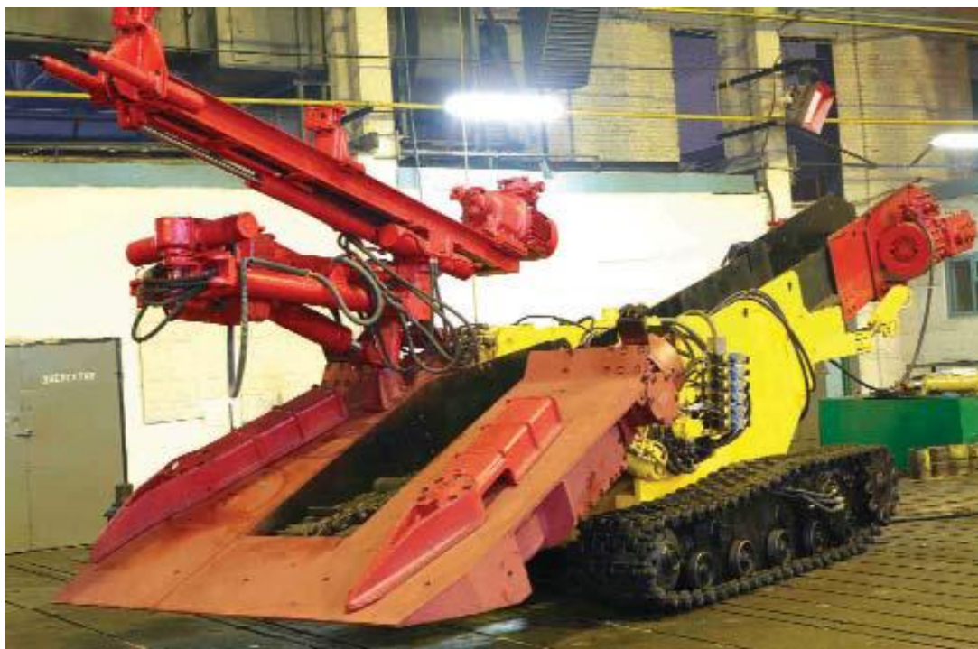
Рис. 4.11. Буропогрузочная машина МПЛ-22
