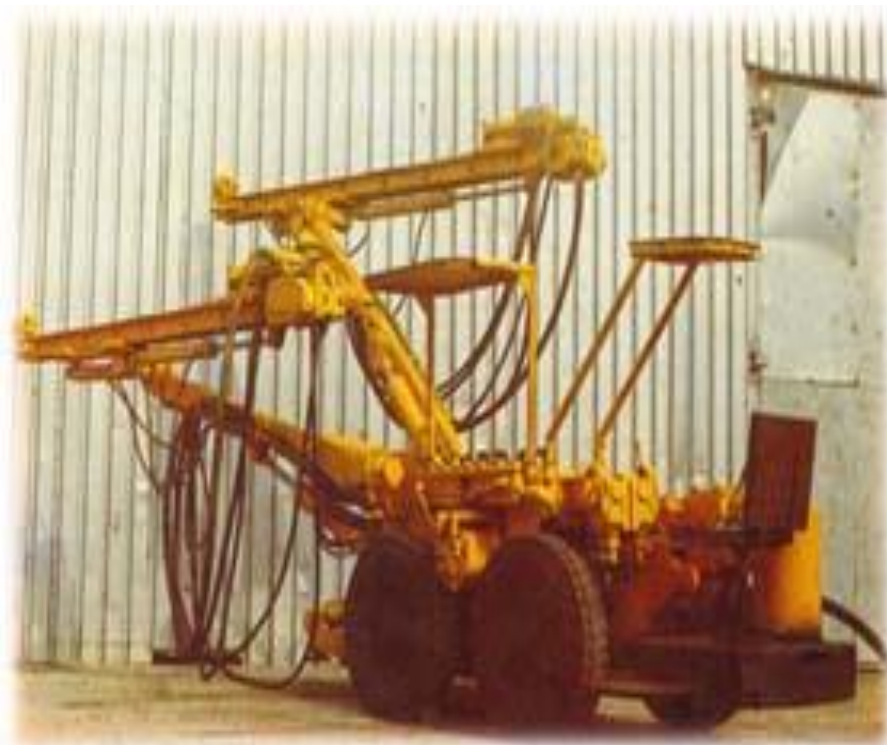
Рис. 4.2. Бурильная установка УБШ-207 на рельсовом ходу, предназначенная для бурения шпуров в горизонтальных горных выработках сечением 6-13 м 2 .
