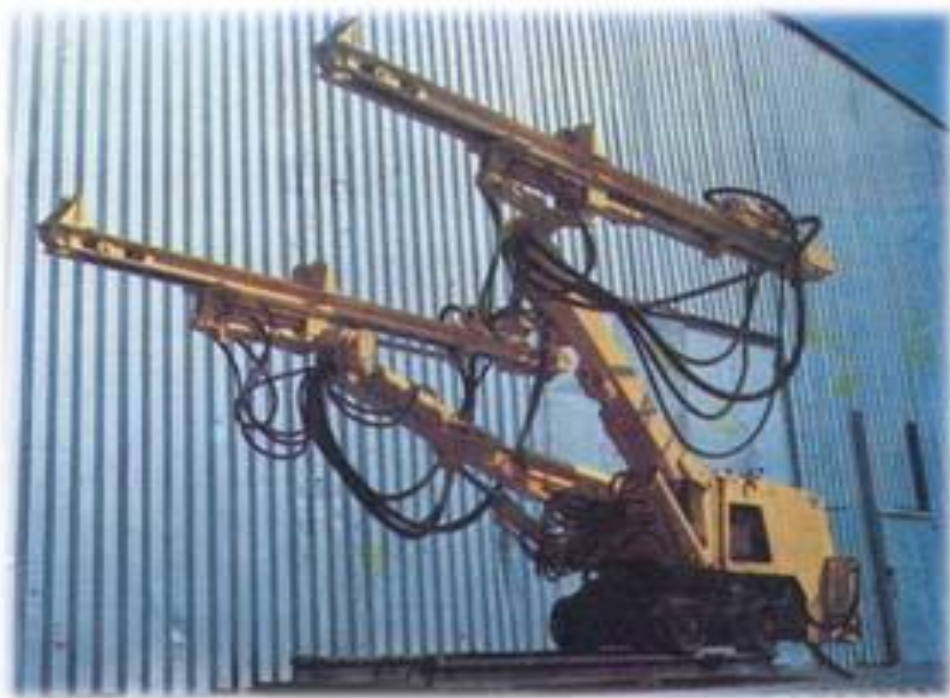
Рис. 4.2. Бурильная установка УБШ-207 на рельсовом ходу, предназначенная для бурения шпуров в горизонтальных горных выработках сечением 6-13 м 2 .
