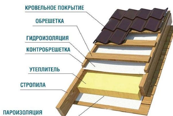
Рис. 4.7 - Вид конструкции кровельного покрытия
