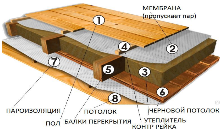
Рис. 3.1. Перекрытие цокольного перекрытия
