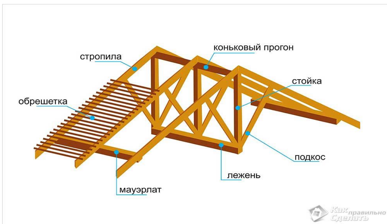
Рисунок 4.4 - Элементы стропильной системы
