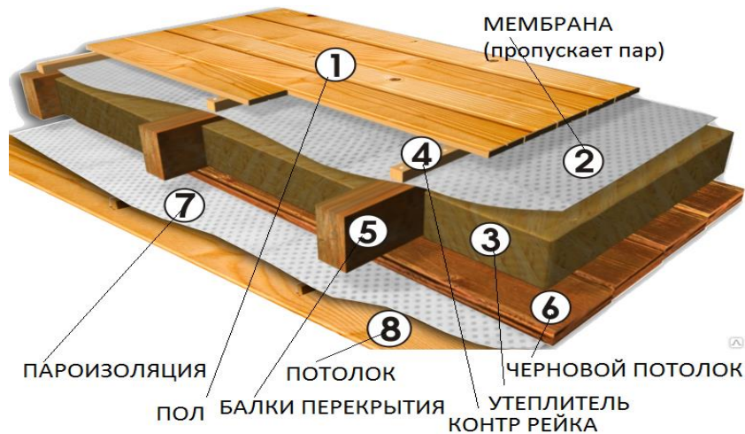
Рис. 3.1. Перекрытие цокольного перекрытия
